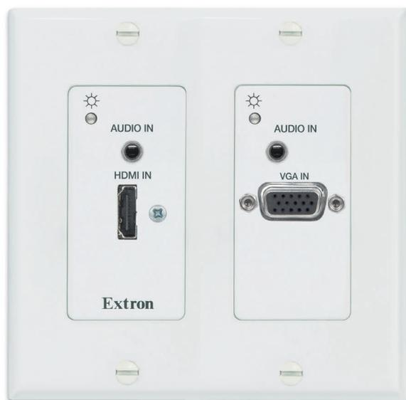
El DTP T UWP 4K 232 D de Extron es un transmisor de estilo Decorator que proporciona extensión de señales de hasta dos fuentes para enviar HDMI, VGA, control y audio analógico hasta 70 m (230 ft) a través de un cable blindado CATx a productos que disponen de DTP® de Extron. Este transmisor es conforme a HDCP e incluye varias características de fácil integración con un práctico formato que ofrece una máxima flexibilidad para su ubicación.
